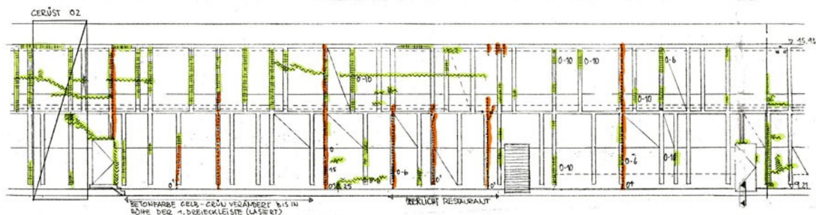
Abb. 10 Allgemeine Schadensaufnahme Beethovensaal Liederhalle Stuttgart
