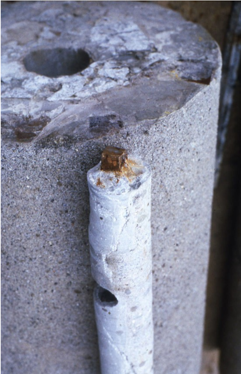
Abb. 40 Überbohrter Eisenstab einer Säule der Friedhofskapelle Jena-Göschwitz
