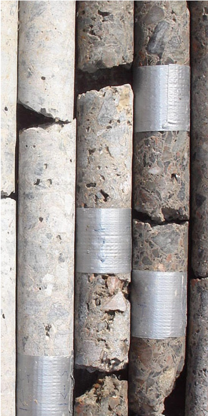
Abb. 14 Bohrkerne zur Verifizierung der Ergebnisse der Georadarsondierung
