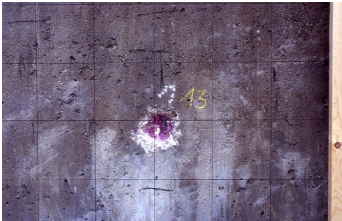
Abb. 17 Lokalisierung betontechnologischer Daten mit Hilfe eines Rahmens, in dem Drähte im Dezimeterraster angeordnet sind
