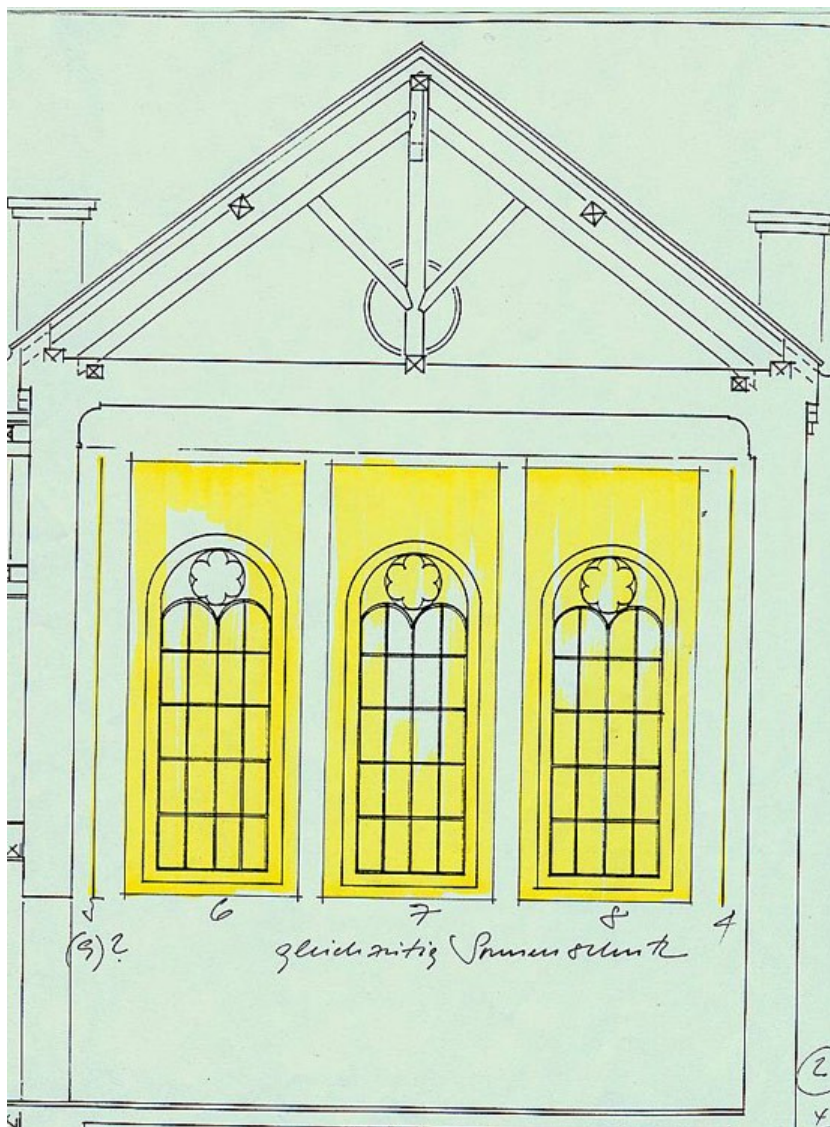
Bild 6 Vorhänge als Absorber in einem ehemaligen Synagogenraum
